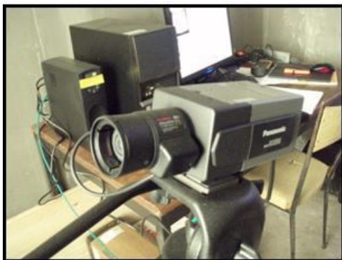
Figure 4 : Dispositif de vidéocomptage
